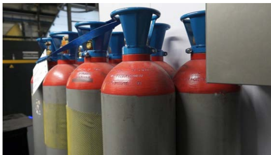
Containers pressurisé contenant de l'isobutène bio-sourcé liquéfié
