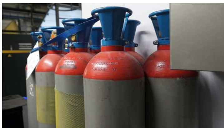
Containers pressurisé contenant de l'isobutène bio-sourcé liquéfié
